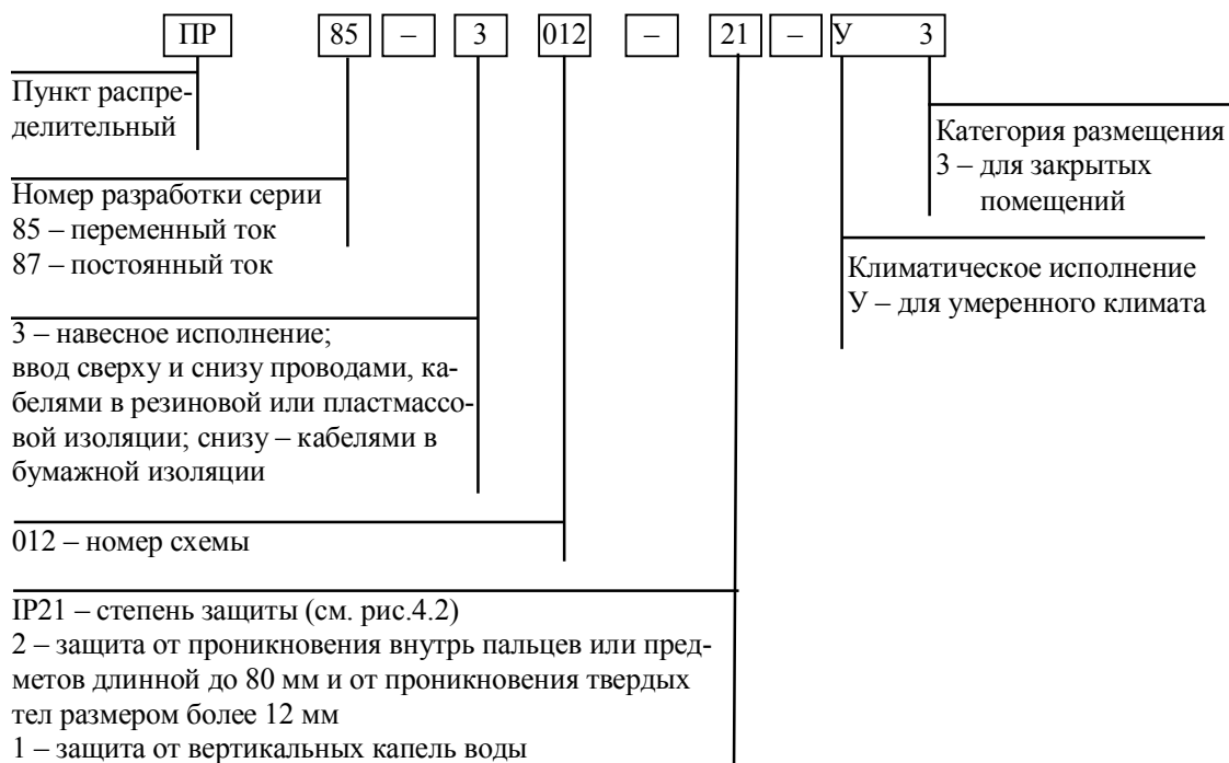
Рис. 4.4. Пример условного обозначения распределительного пункта серии ПР85
