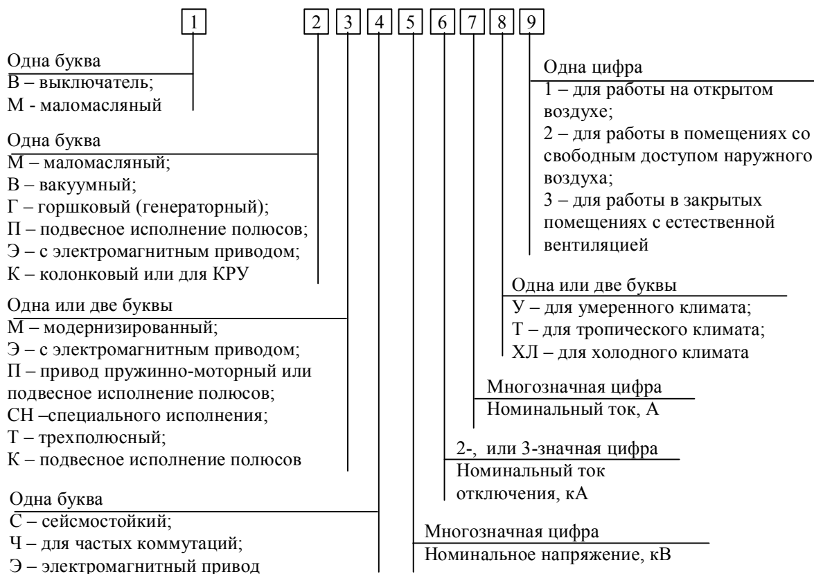
Рис.5.2. Структура условного обозначения выключателей высокого напряжения
