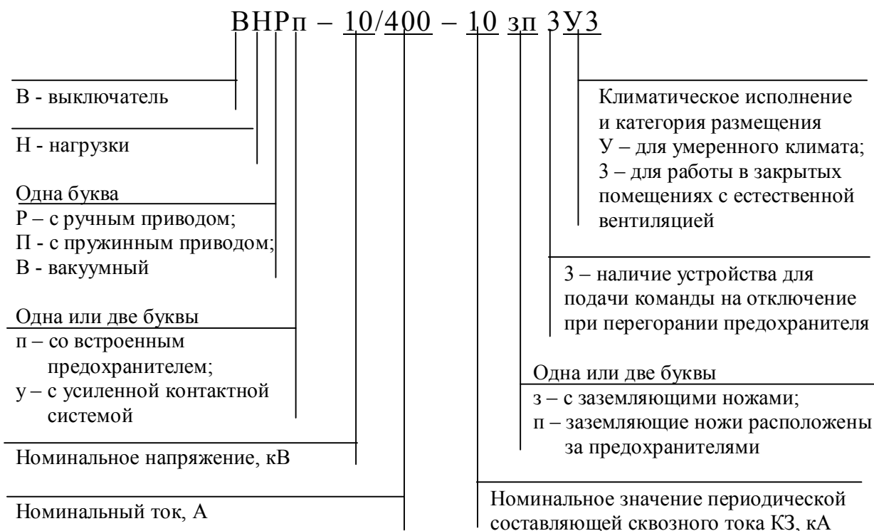
Рис.5.3. Структура условного обозначения выключателей нагрузки
