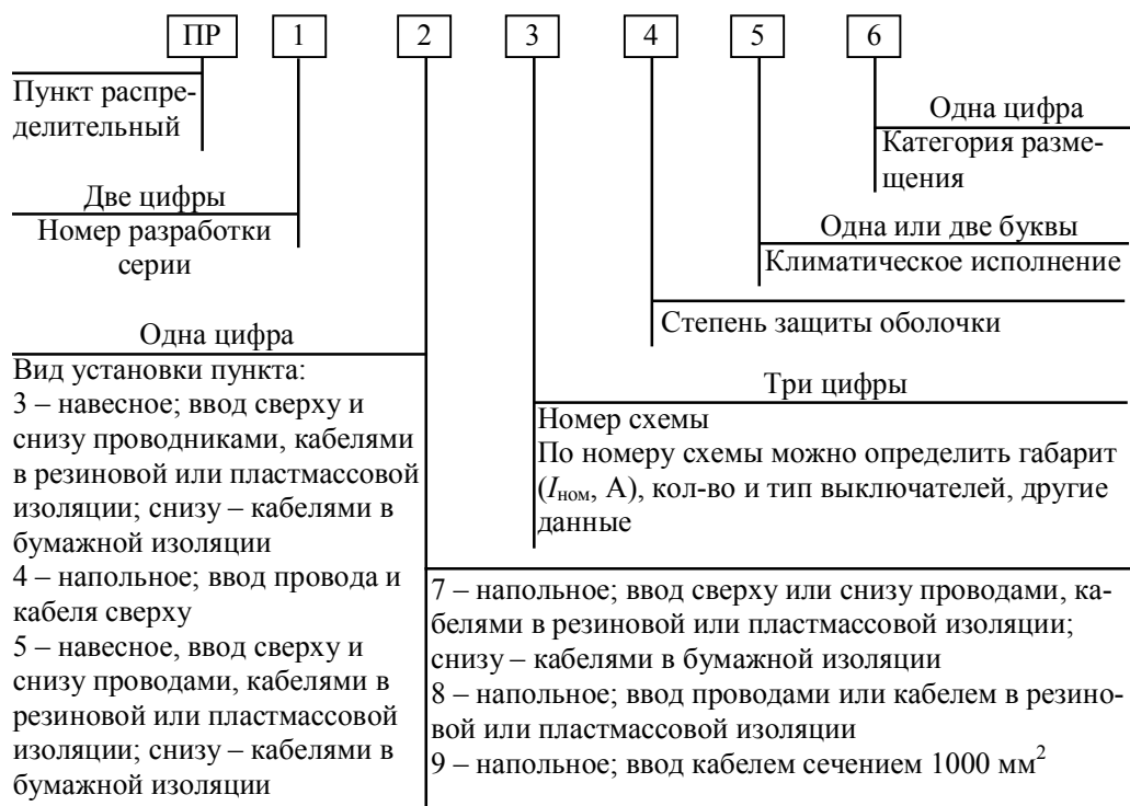
Рис. 4.3. Структура условного обозначения распределительных пунктов серии ПР85 и ПР87
